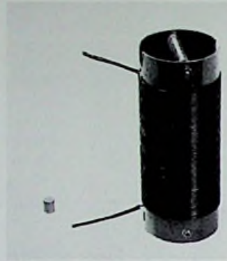
Bild 1: Größenvergleich der Vogt-Hochfrequenzspule von 1933 mit einer bis dahin üblichen Luftspule (Vogt-Pressbild)
